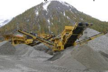
sotto: vaglio mobile con quattro tipi di selezione
